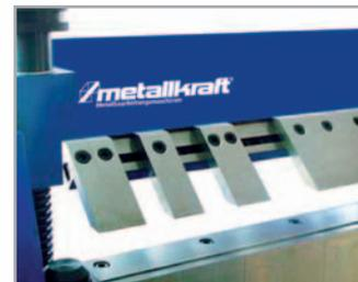
Fig.: **Tablier segmenté**
