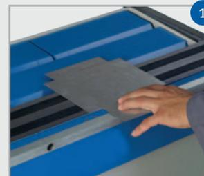
*Etape 2: Sélectionnez le segment approprié, placez-le sur la pièce à usiner et activez l'électro-aimant*
