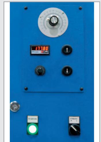
• Panneau de commande optionnel PUD avec écran digital. Réglage manuel de l'angle de pliage et pilotage motorisé des butées arrière
