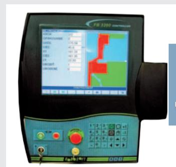
• Panneau de commande optionnel FB 3200 2D : écran couleur tactile 15" TFT, Multifonctions et interface Linux 2D, base de donnée matières et interface USB
