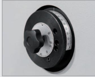
• De série avec contrôle manuel (MA) de l'angle de pliage. Volant gradué situé sur le montant gauche de la machine
