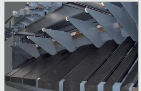
· Le dispositif de chargement pneumatique évite la tôle d'être déformée avant la coupe. Idéal pour les coupes nettes de tôles fines (dispositif optionnel)
