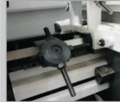
Fig.: Butée réglable 4 positions
